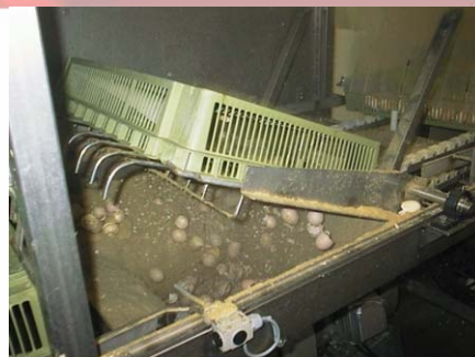
El volteador de bandejas vacía una cesta de nacimiento girándola 180 ° y expulsando su contenido
